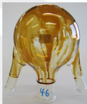
Масло 10W-40 не прошло тест Daimler Oxidation Test
