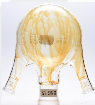
Премиум HDEO 10W-40 на основе пакета А успешно прошло тест Daimler Oxidation Test
